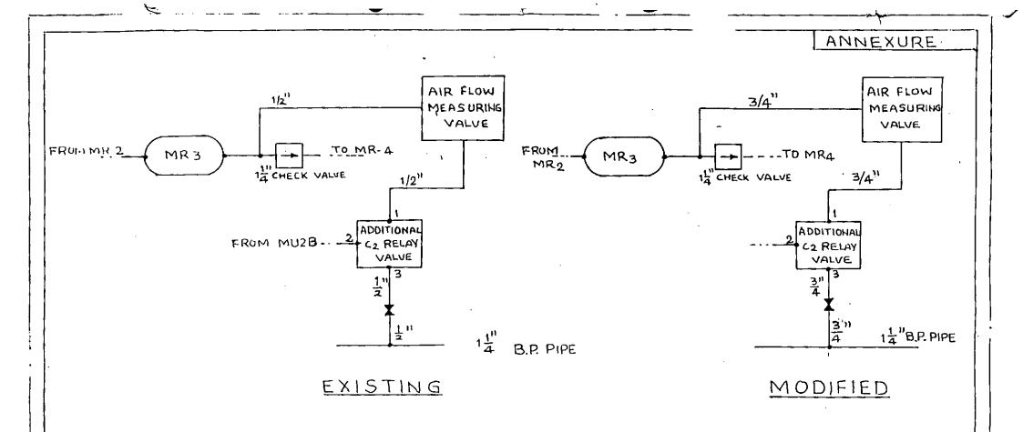
SCHEMATIC SHOWING CHANGES REQUIRED IN BRAKE PIPE
